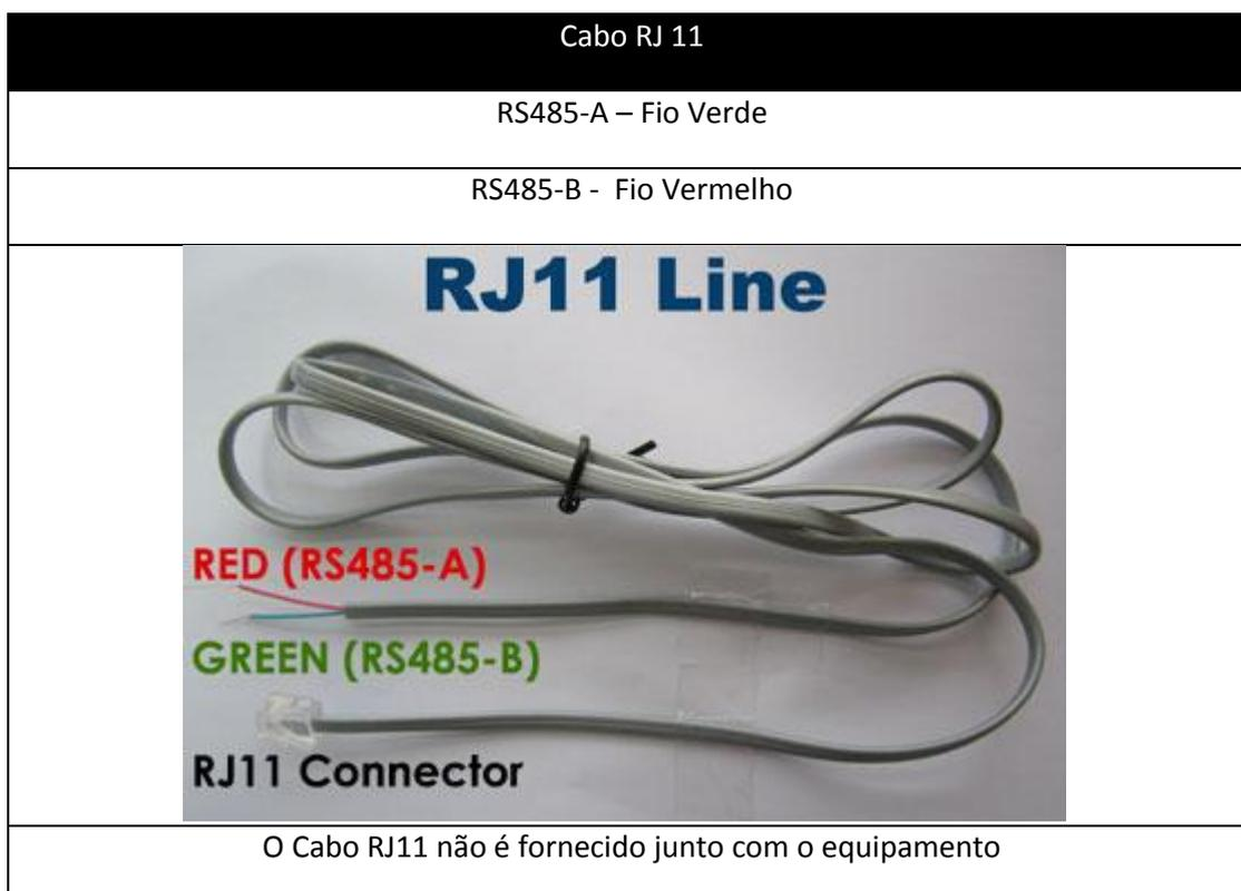
**1 Passo :** Obter um cabo RJ11 com o comprimento adequado para sua aplicação.
