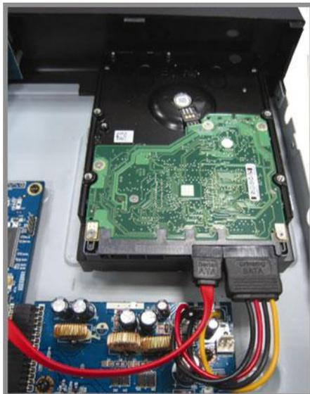
**4º Passo :** Alinhe o orifício do parafuso no suporte de cada um com o furo do parafuso lateral do HDD como mostrado abaixo, e fixar o disco rígido no suporte com um parafuso de HDD fornecidos.
